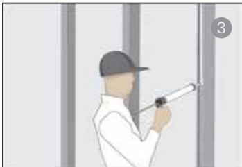
3. ยิงกาวพลังตะปูที่กลักรับแนวเทพกาวที่ติดไว้ก่อนหน้า โดยยิงกาวพลังตะปูให้เป็นเส้นตลอดแนวเทพกาว และโครง C-Stud
