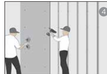
4. ยึดแผ่นขึ้นงานกับโครงเหล็กเข้าด้วยกันโดยการยิงรีเวทด้วยเครื่องยิงรีเวท ให้ครบตามมาตรฐานการติดตั้ง ทำวิธีการเดินต่อไปเรื่อยๆ ครอบคลุมระหว่างแผ่นให้ได้รับระดับและแนบสนิท
