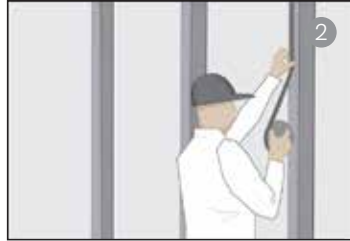
2. ติดตั้งเทพกาวที่โครงเหล็ก ตามแนวโครงเหล็กตลอดแนว (ตามระยะมาตรฐานการติดตั้ง)
