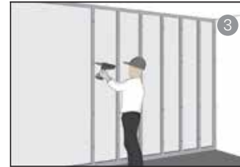
3. ยกแผ่นขึ้นทาบกับโครง C-Stud เพื่อที่จะเจาะรูโครงเหล็กให้ตรงกับรูที่เจาะไว้ที่แผ่นขึ้นงานก่อนหน้าและทำการยึดเทปกาวตลอดหน้าโครง C-Stud
