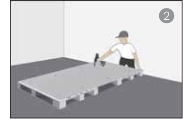
2. วัตรเยกทำตำแหน่งเพื่อเจาะรูที่แผ่นเชื่อมงานด้วยสว่าน ตามระยะมาตรฐานการติดตั้ง
